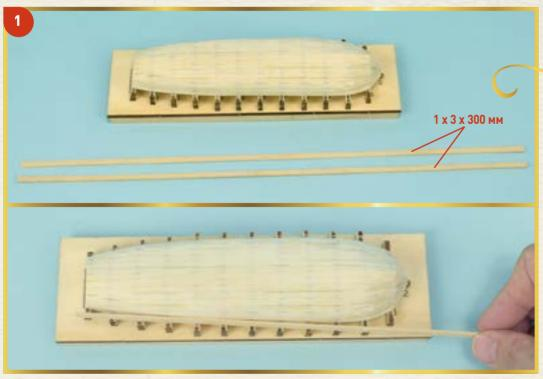
1 Сегодня мы продолжим сборку второй шлюпки нашей модели. Прежде всего вам следует приклеить две планки к краям обшивки шлюпки. С этой целью отрежьте от планки 1 х 3 х 300 мм фрагменты нужной длины. Данная операция идентична той, которую вы уже выполняли, собирая первую шлюпку в соответствии с инструкциями выпуска 7.
