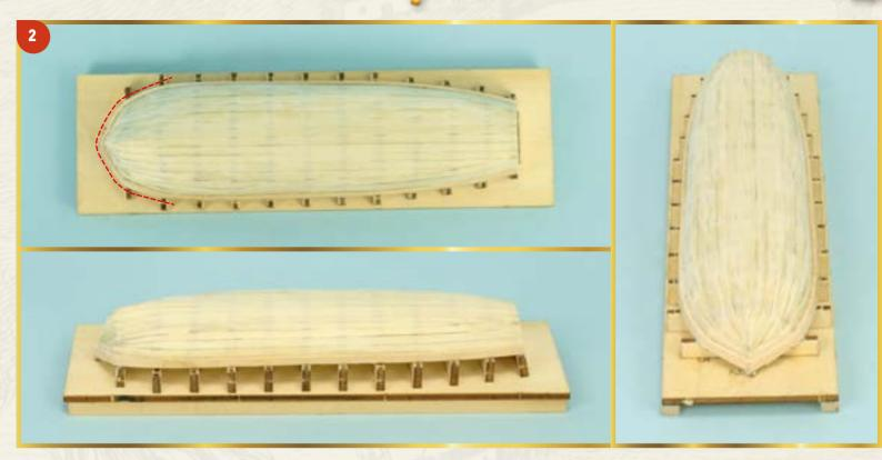
2 Передние концы обеих планок загните таким образом, чтобы они соответствовали изгибу носовой части шлюпки. Самый легкий способ добиться этого — слегка намочить планку водой и нагреть ее при помощи электрического сгибателя. Подготовив планки, приклейте их (по одной на каждый борт) вдоль края обшивки. В носовой части обе планки должны соприкасаться друг с другом, а на корме их следует обрезать вровень с транцем.
